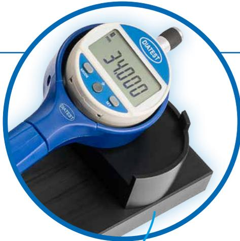
Schale für Messuhr und Anzeigeeinheit
